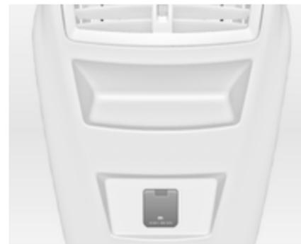
Une prise de courant 230 V est placée dans la console de plancher arrière. Si le contact est mis et qu'un appareil est branché, une LED s'allume en vert dans la prise.
