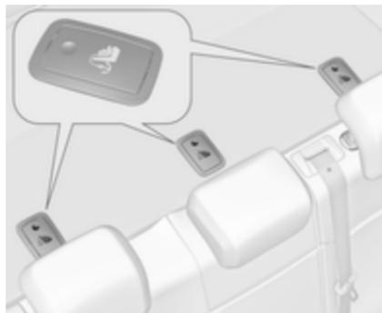
Attacher les systèmes de sécurité pour enfant Top-Tether aux anneaux de fixation à l'arrière des appuis-tête arrière ou à l'arrière des dossiers
