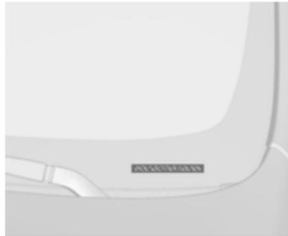
Le numéro d'identification du véhicule est visible à travers la pare-brise.
