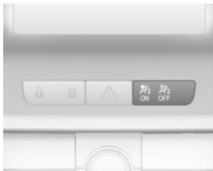
Ce n'est que si le témoin
