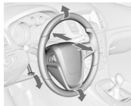
Débloquer le levier, régler le volant puis bloquer le levier et vérifier qu'il est bien verrouillé. Ne régler le volant que lorsque le véhicule est arrêté et la direction débloquée.
