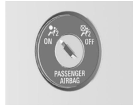
Le système d'airbags de passager avant peut être désactivé à l'aide d'une serrure située sur le côté du tableau de bord, visible quand la porte passager est ouverte.
