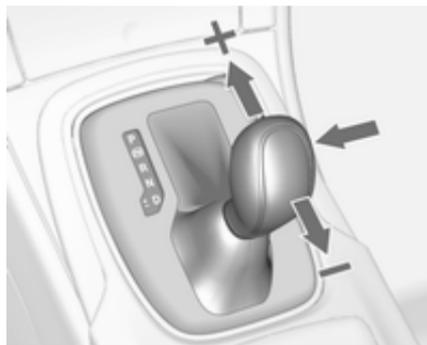
Déplacer le levier sélecteur de la position **D** vers la gauche puis vers l'avant ou l'arrière.
