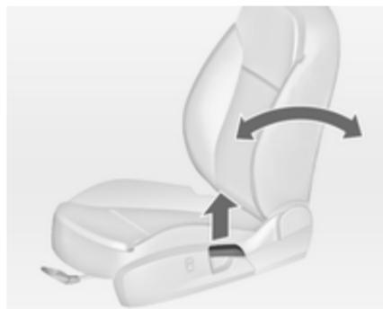
Tirer la manette, régler l'inclinaison et relâcher la manette. Laisser le siège s'encliqueter de manière audible. Ne pas s'appuyer sur le dossier pendant le réglage.
