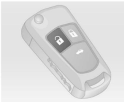
Appuyer sur le bouton
