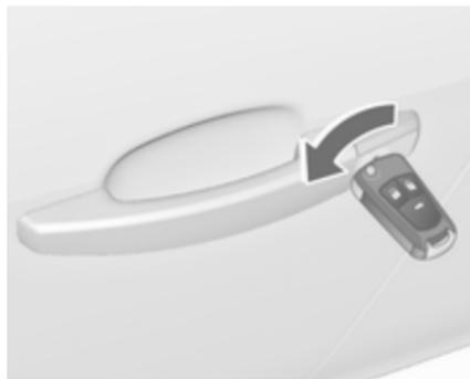
Déverrouiller manuellement la porte du conducteur en tournant la clé dans la serrure. Mettre le contact et appuyer sur le bouton de verrouillage central
