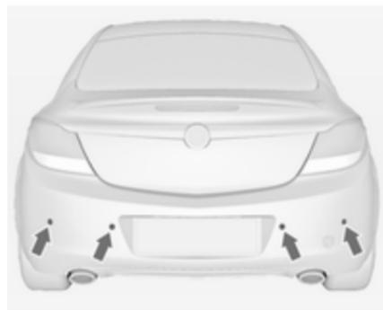
L'aide au stationnement facilite les manœuvres de stationnement en mesurant la distance entre le véhicule et les obstacles et en émettant un signal sonore dans l'habitacle. C'est toutefois le conducteur qui reste pleinement responsable du stationnement.
