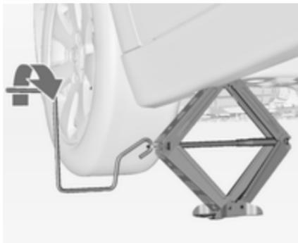
4. Régler le cric à la hauteur requise avant de le positionner directement sous le point de levage de manière telle qu'il ne glisse pas.
