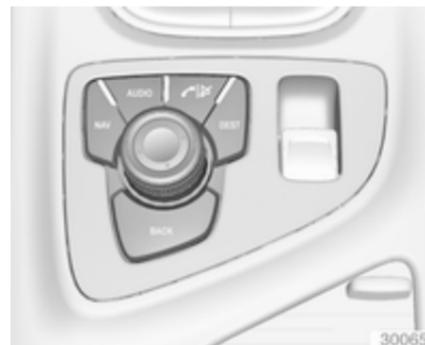
Sélectionner les options via les menus et les boutons de l'Infotainment System. Le bouton rotatif multifonction est utilisé pour sélectionner un élément et pour confirmer.
