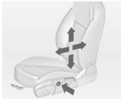
Ajuster le soutien lombaire en utilisant le commutateur à quatre positions sur le côté extérieur du siège conducteur en fonction de vos desiderata personnels.
