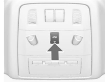
Arrêter la surveillance de l'habitacle et de l'inclinaison du véhicule quand des personnes ou des animaux restent dans le véhicule, en raison de leurs mouvements et de la grande quantité de signaux ultrasoniques, et quand le véhicule est à bord d'un ferry ou d'un train.
