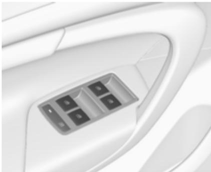
Appuyer sur le commutateur
