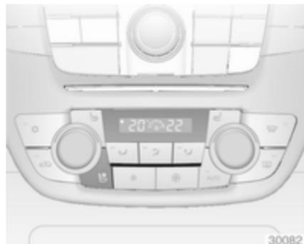
En fonction du niveau de ventilation voulu, appuyer une ou plusieurs fois sur le bouton
