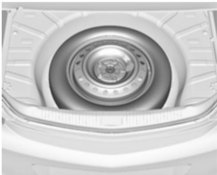
La roue de secours se trouve dans le coffre, sous le recouvrement de plancher. Elle est fixée dans une niche par un écrou papillon.
