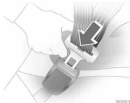
Le port de vêtement larges ou épais gêne la position tendue de la ceinture. Ne pas placer d'objets, comme un sac à main ou un téléphone portable, entre la ceinture et le corps.
