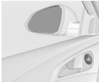
Sélectionner le rétroviseur extérieur adéquat en tournant le bouton de commande vers la gauche (**L**) ou la droite (**R**). En position **0**, aucun rétroviseur n'est sélectionné.
