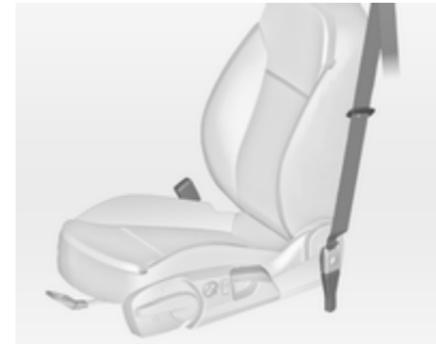
Les ceintures de sécurité des sièges avant sont tendues en cas de collision avant et arrière d'une certaine gravité.
