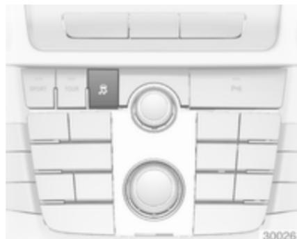
Le TC peut être désactivé quand le patinage des roues est requis : appuyer sur le bouton
