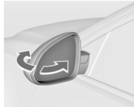
Pour la sécurité des piétons, les rétroviseurs extérieurs se rabattent s'ils sont violemment heurtés. Repositionner le rétroviseur en appuyant légèrement sur son boîtier.
