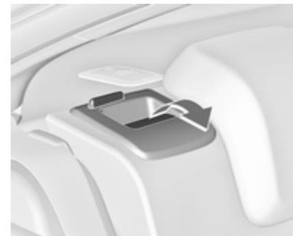
Pour relever les dossiers, les soulever et les guider jusqu'en position verticale jusqu'à ce qu'ils se verrouillent de manière audible.
