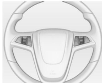
Les fonctions de l'Infotainment System et du régulateur de vitesse peuvent être commandées à partir du volant.
