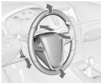
Débloquer le levier, régler le volant puis bloquer le levier et vérifier qu'il est bien verrouillé.
