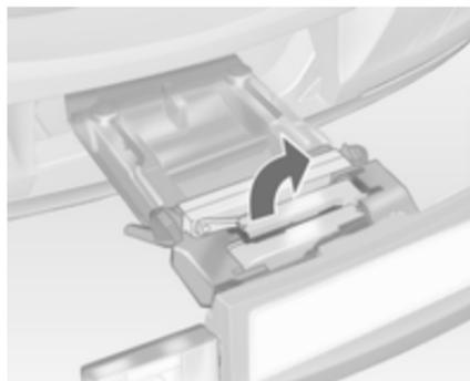
Plier un logement de pédalier, ou les deux, vers le haut jusqu'à ce que le support diagonal s'engage.
