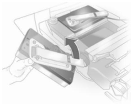
Ouvrir complètement le support d'ampoule au dos du feu arrière jusqu'à la butée.
