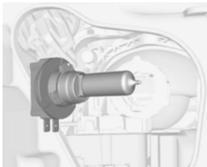
3. Introduire la nouvelle ampoule dans le réflecteur de sorte que l'ergot de positionnement de la douille de l'ampoule soit aligné avec le logement du réflecteur.
