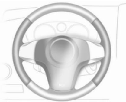
Quand le moteur tourne et pendant un Autostop, le volant est chauffé dans les zones représentées sur l'illustration ci-dessus.
