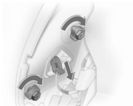
2. Débrancher la fiche en appuyant sur l'ergot de la douille de l'ampoule.
