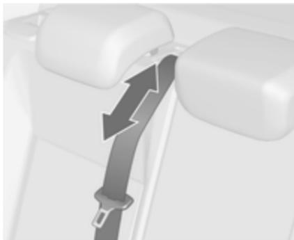
La ceinture de sécurité du siège central peut être bloquée quand le dossier est relevé trop rapidement. Pour débloquer l'enrouleur, rentrer la ceinture de sécurité ou la sortir d'environ 20 millimètres, puis la laisser aller.
