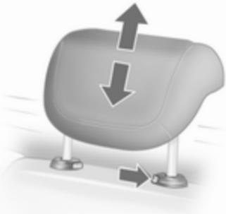
La hauteur des appuis-tête peut être réglée en deux positions. Pour régler l'appui-tête à la première position, le tirer vers le haut ; pour la seconde position, appuyer sur le ressort indiqué sur l'illustration et pousser l'appui-tête verticalement vers le haut. Pour abaisser l'appui-tête, appuyer sur le ressort indiqué sur l'illustration et pousser l'appui-tête vers le bas.
