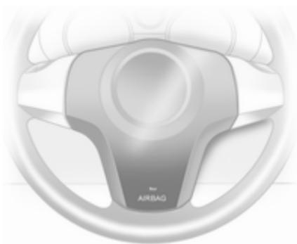
Le système d'airbags avant se compose de deux airbags, un dans le volant et un autre dans le tableau de bord en face du passager avant. Ils sont reconnaissables à l'inscription **AIRBAG**.
