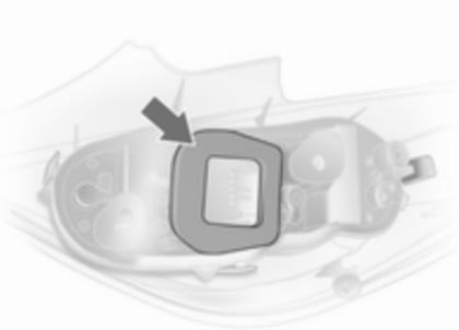
8. S'assurer que le joint de douille de l'ampoule est positionné comme illustré. Poser le joint rond sur la vis de fixation.
