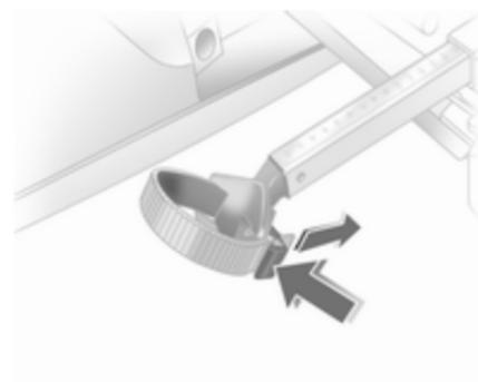
Insérer le dispositif de retenue par sangle et le tirer vers le bas au maximum.
