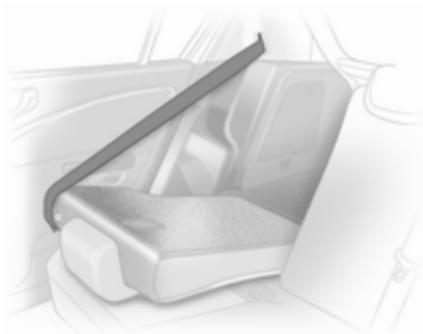
Déverrouiller le dossier (en une pièce ou séparé) en utilisant la poignée de déverrouillage et le rabattre sur l'assise du siège.
