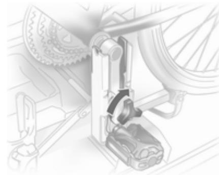
Bloquer la manivelle de pédale en tournant la vis de blocage sur la fixation de pédalier.
