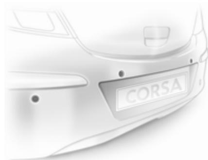
L'aide au stationnement facilite les manœuvres en mesurant la distance entre le véhicule et les obstacles. C'est toutefois le conducteur qui reste pleinement responsable du stationnement.
