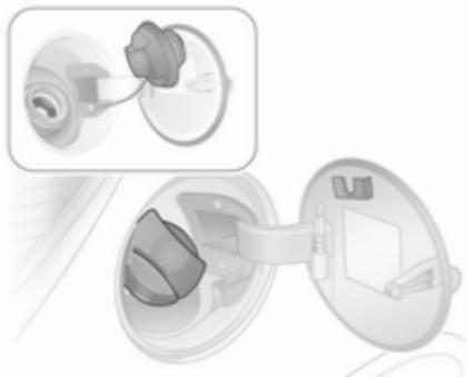
Déverrouiller le bouchon de remplissage avec la clé du véhicule. Pour ouvrir, tourner le bouchon lentement vers la gauche. Le bouchon de remplissage peut être déposé dans le support sur la trappe à carburant.
