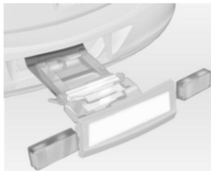
Vérifier la position des câbles et des feux pour s'assurer qu'ils sont correctement montés et positionnés.
