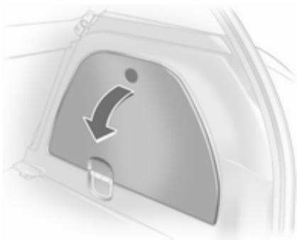
Le kit de réparation des pneus se trouve dans le compartiment de rangement du coffre.
