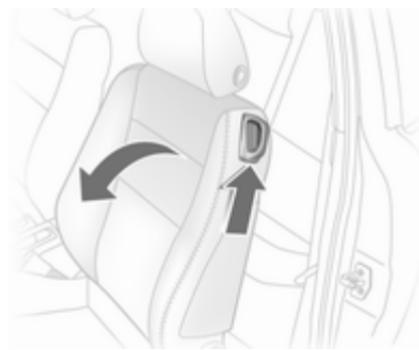
Soulever la poignée de déverrouillage et basculer le dossier vers l'avant. Abaisser la poignée de déverrouillage et le dossier s'engage en position basse. Coulisser le siège vers l'avant.
