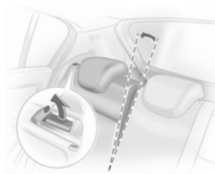
Tirer la manette de déverrouillage, tirer le dossier vers l'avant en position verticale et le verrouiller.
