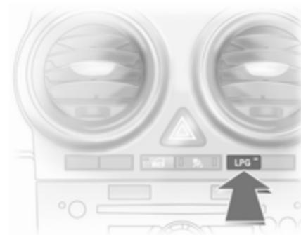
Le bouton **LPG** permet de choisir entre mode essence et mode gaz liquéfié. La LED
