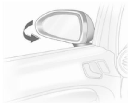
Les rétroviseurs extérieurs peuvent être rabattus en appuyant légèrement sur le bord extérieur du boîtier.
