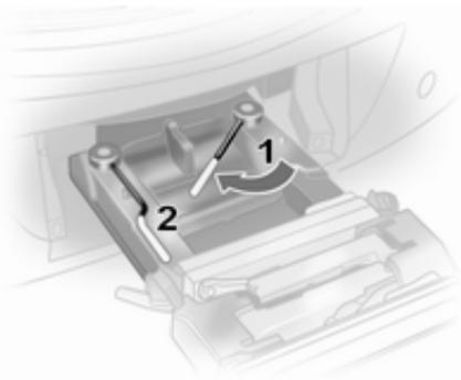
Pivoter d'abord le levier de blocage droit (1) vers l'intérieur, puis le levier de blocage gauche (2) jusqu'à ce qu'ils puissent être engagés dans leur logement respectif.
