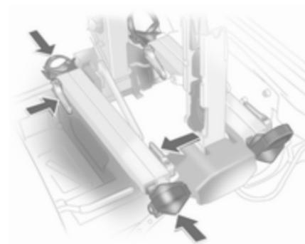
Appuyer sur la poignée de déverrouillage et coulisser les logements de roue aussi loin que possible.
