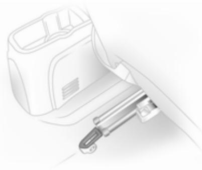
Le garnissage du montant de toit arrière et les points de fixation comportent des symboles indiquant les œilletons de fixation auxquels le système de sécurité pour enfant doit être attaché.
