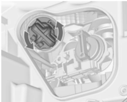
2. Faire tourner la douille de l'ampoule dans le sens antihoraire pour la désencliqueter. Extraire la douille de l'ampoule de son réflecteur.
