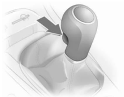
Marche arrière : lorsque le véhicule est à l'arrêt, enfoncer le bouton de déverrouillage du levier sélecteur 3 secondes après avoir enfoncé la pédale d'embrayage et engager la marche arrière.
