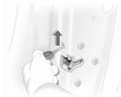
Introduire la clé dans l'ouverture au-dessus de la serrure à l'intérieur de la porte et manœuvrer la serrure en soulevant la clé jusqu'au déclic. Fermer alors la porte. La procédure doit être effectuée pour chaque porte. La porte du conducteur peut aussi être verrouillée depuis l'extérieur à l'aide de la clé. La trappe à carburant et le hayon ne peuvent pas être verrouillés.
