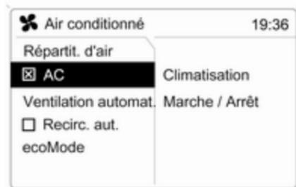
Dans le menu **Air conditionné**, sélectionner l'option **AC** et allumer ou éteindre le refroidissement.
