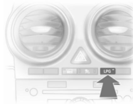
L'actionnement du bouton **LPG** permet de basculer entre les modes de fonctionnement à l'essence et au gaz de pétrole liquéfié dès que les paramètres requis (température de liquide de refroidissement et régime moteur minimal) ont été atteints. Les exigences sont généralement satisfaites environ après 60 secondes (en fonction de la température extérieure) et le premier enfoncement net de la pédale d'accélérateur. La LED indique le mode de fonctionnement en cours.
