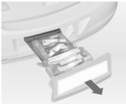
Sortir complètement le système de transport arrière jusqu'à ce que vous entendiez un déclic de verrouillage.
