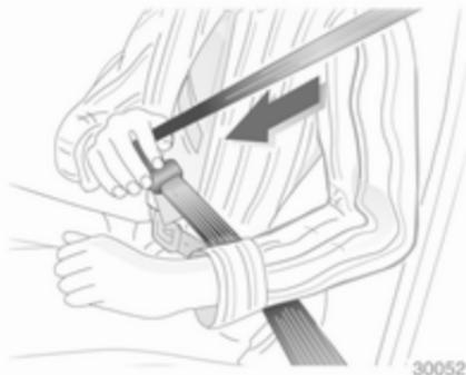
Tirer la ceinture hors de l'enrouleur, la guider sur le corps sans la vriller et insérer le verrou plat dans la ceinture. En roulant, tendre régulièrement la sangle abdominale en tirant sur la sangle thoracique.
