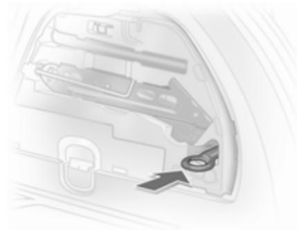
L'œillet de remorquage se trouve dans l'outillage du véhicule ↻ 179. L'œillet de remorquage est rangé dans un logement.
