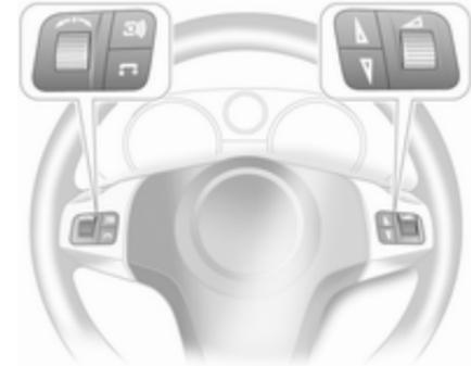
Les fonctions de l'Infotainment System et de l'Info-Display peuvent être commandées à partir des boutons du volant.
