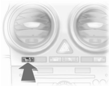
Enclencher le chauffage, en association avec le chauffage de siège, en appuyant sur le bouton
