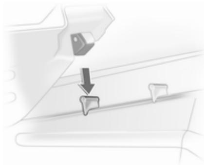
Pour enlever les trois autres éléments (dans l'ordre de 2 à 4), les soulever à l'arrière, les déverrouiller, les tourner et les enlever.
