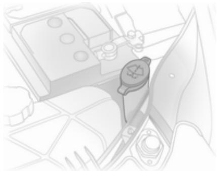
Remplir avec de l'eau propre mélangée d'une quantité adéquate de liquide de lave-glace contenant de l'antigel. La composition correcte du mélange est indiquée sur le réservoir du liquide de lave-glace.
