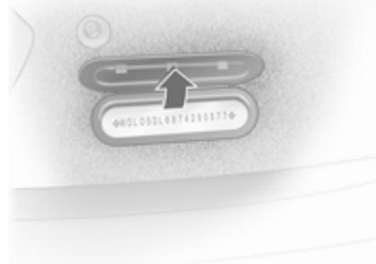
Le numéro d'identification du véhicule est frappé sur la plaquette signalétique et sur le plancher, sous le tapis de sol, abrité par un cache.
