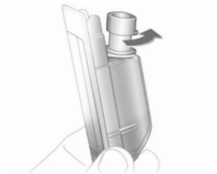
4. Faire tourner la douille de l'ampoule dans le sens antihoraire pour la désencliquer.
