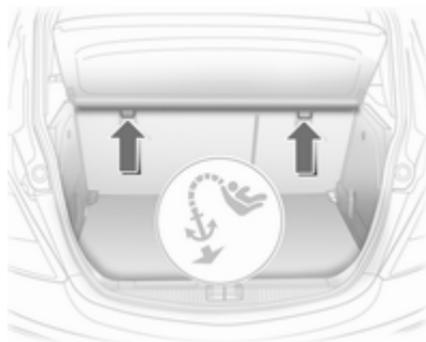
En fonction des équipements spécifiques au pays, le véhicule peut être doté de deux ou trois œilletons d'attache.
