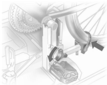
Détacher les dispositifs de retenue par sangle sur les deux roues du vélo.
