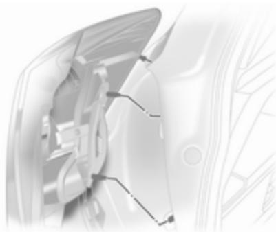
4. Détacher le boîtier de l'ampoule vers l'arrière.
