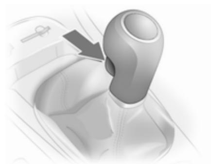
Pour engager la marche arrière : lorsque le véhicule est à l'arrêt, appuyer sur le bouton de déverrouillage du levier sélecteur 3 secondes après avoir enfoncé la pédale d'embrayage et engager la marche arrière.
