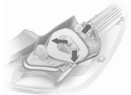
5. Appuyer légèrement sur les trois pattes de verrouillage sur l'extérieur de la douille de l'ampoule et enlever la douille de l'ampoule.
