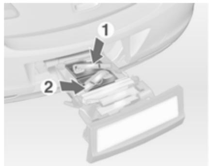
Replier les supports d'ampoules au dos des feux arrière.
