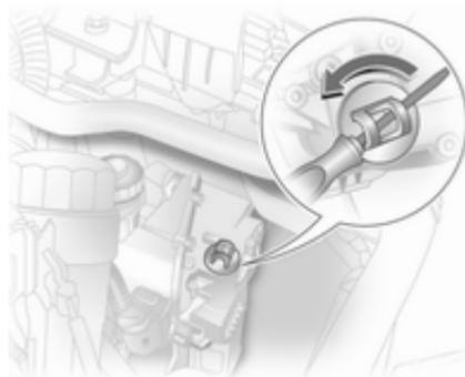
Si le véhicule doit être amené en dehors du trafic, débrayer la transmission comme suit :
