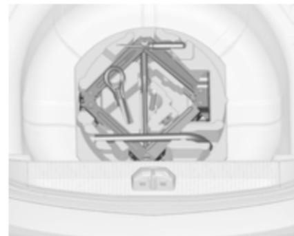
Variante 1 : le cric et les outils du véhicule sont rangés dans le coffre sous la roue de secours. Une étiquette sur le cric indique les véhicules pour lesquels le cric peut être utilisé.
