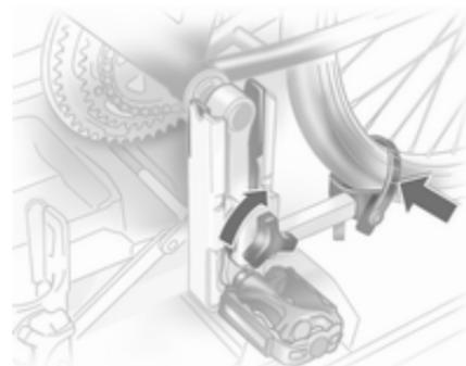
Serrer la vis de blocage de la fixation de pédalier au maximum à la main.
