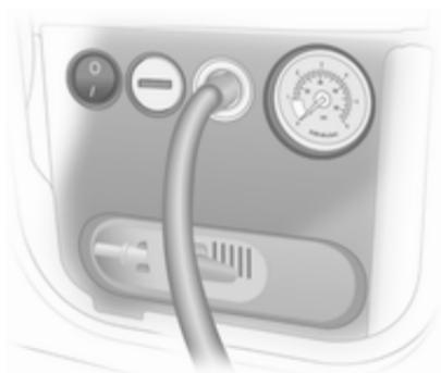
8. Appuyer sur le commutateur marche/arrêt pour démarrer le compresseur. Le pneu se gonfle en aspirant le produit d'étanchéité.
