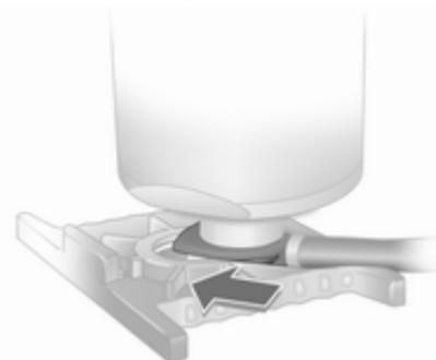
3. Mettre la bouteille de produit d'étanchéité sur le support. S'assurer que la bouteille ne se retourne pas.
