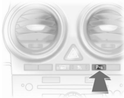
Si le véhicule est doté du bouton **P**▲, le système peut être désactivé en enfonçant le bouton.
