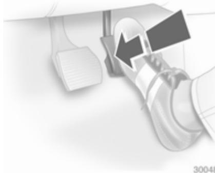
En enfonçant la pédale d'accélérateur au-delà du point de résistance, un rapport inférieur est sélectionné en fonction du régime moteur.
