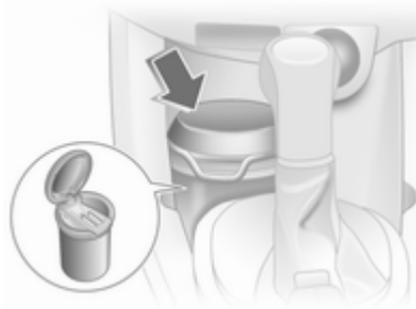
Le cendrier amovible peut être placé dans les porte-gobelets. Ouvrir le couvercle avant utilisation.
