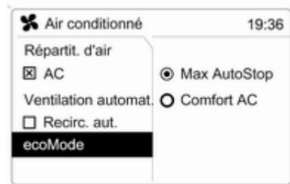
Sur les véhicules avec système Stop/Start, deux réglages de fonctionnement du système de climatisation sont disponibles pendant un Autostop.
