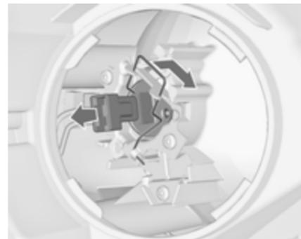
3. Désencliqueter la languette-ressort de l'attache en la déplaçant et la pivotant sur le côté.
