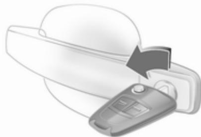
Tourner au maximum la clé dans la serrure de la porte du conducteur. Tout le véhicule est déverrouillé quand la porte du conducteur est ouverte. Pour déverrouiller les autres portes, mettre le contact et appuyer sur le bouton de verrouillage central.
