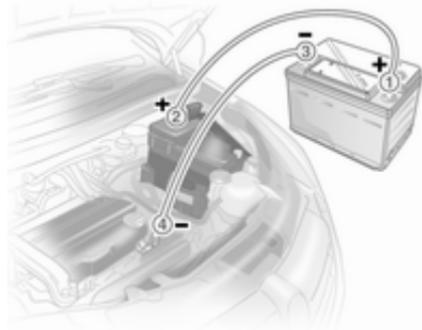
Positionner les câbles de sorte qu'ils ne puissent pas être happés par des pièces en mouvement dans le compartiment moteur.
