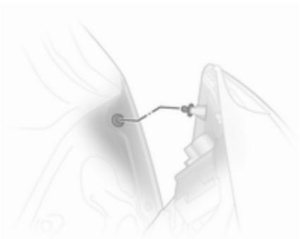
9. Introduire le boîtier de l'ampoule dans la carrosserie, serrer les écrous de fixation à la main. Brancher la fiche. Fermer le cache.
