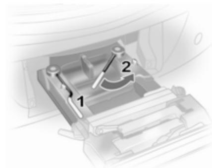
Basculer d'abord le levier de blocage gauche (1), puis le levier de blocage droit (2) jusqu'à ce qu'ils viennent en butée. Les deux leviers de blocage doivent être dirigés vers l'arrière, sinon la sécurité de fonctionnement n'est pas garantie.
