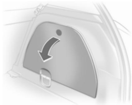
Pour ouvrir le compartiment, désencliqueter le couvercle et l'ouvrir.
