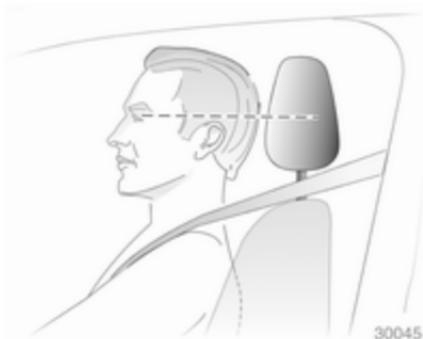
Le milieu de l'appui-tête doit se trouver à hauteur des yeux. Si cela s'avérait impossible pour des personnes de très grande taille, l'appui-tête doit être réglé sur la position la plus haute.
