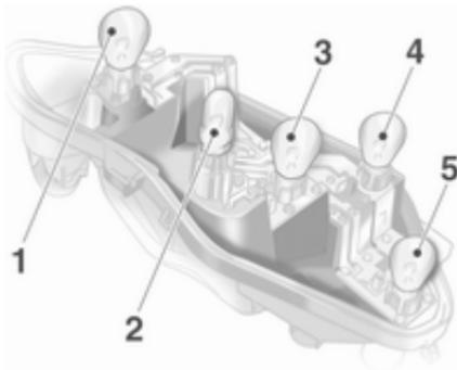
6. Pousser légèrement l'ampoule dans la douille, la tourner dans le sens antihoraire, l'enlever et remplacer l'ampoule.
