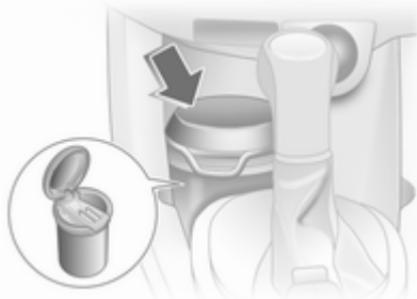
Boîtier de cendrier pour une utilisation portable dans le véhicule. Pour l'employer, ouvrir le couvercle.
