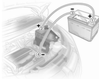
Placer les câbles de sorte qu'ils ne puissent pas être happés par des pièces en mouvement dans le compartiment moteur.
