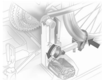
Détacher les dispositifs de retenue par sangle sur les deux roues du vélo.
