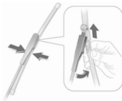
Soulever le bras d'essuie-glace, pivoter le balai à 90° par rapport au bras et le déplacer sur le côté.
