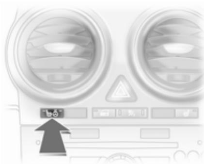
Enclencher le chauffage, en association avec le chauffage de siège, en appuyant sur le bouton
