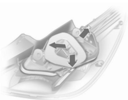
5. Appuyer légèrement sur les trois pattes de verrouillage sur l'extérieur de la douille de l'ampoule et enlever la douille de l'ampoule.
