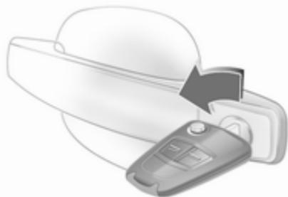
Tourner au maximum la clé dans la serrure de la porte du conducteur. Tout le véhicule est déverrouillé quand la porte du conducteur est ouverte. Pour ouvrir les autres portes, mettre le contact et appuyer sur le bouton de verrouillage central.
