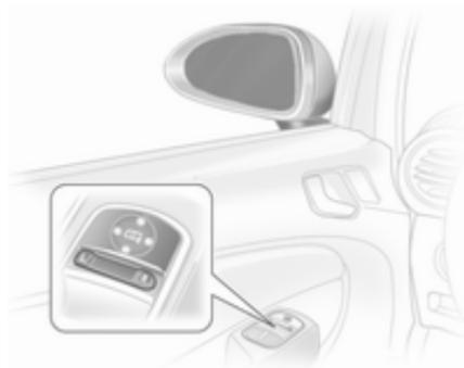
Commencer par sélectionner le rétroviseur extérieur souhaité, puis utiliser la commande pour le régler.
