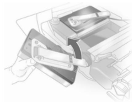
Ouvrir complètement le support d'ampoule au dos du feu arrière.
