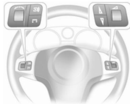
Les fonctions de l'Infotainment System et de l'Info-Display peuvent être commandées à partir des boutons du volant.
