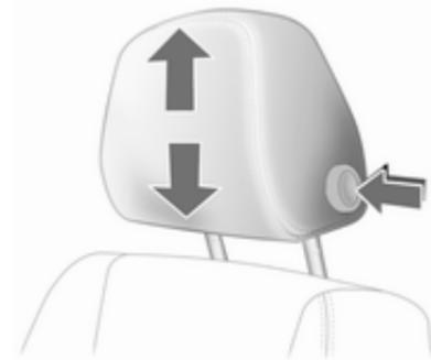
Appuyer sur le bouton, régler la hauteur et encliqueter
