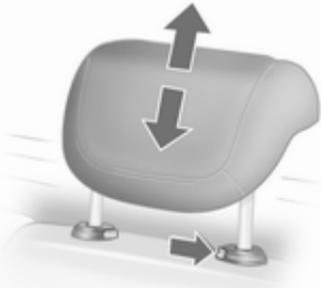
La hauteur des appuis-tête peut être réglée en deux positions. Pour régler l'appui-tête à la première position, le tirer vers le haut ; pour la seconde position, appuyer sur le ressort indiqué sur l'illustration et pousser l'appui-tête verticalement vers le haut. Pour abaisser l'appui-tête, appuyer sur le ressort indiqué sur l'illustration et pousser l'appui-tête vers le bas.
