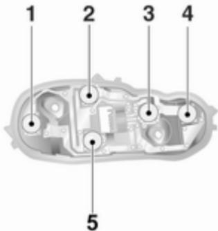
6. Pousser légèrement l'ampoule dans la douille, la tourner dans le sens antihoraire, l'enlever et remplacer l'ampoule.
