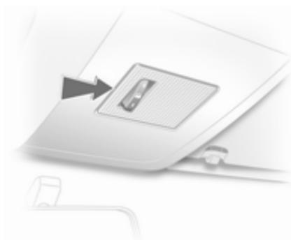
1. Désencliquer la lentille et l'enlever par l'endroit marqué sur l'illustration en utilisant un tournevis.
