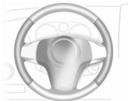
Quand le moteur tourne, le volant est chauffé dans les zones représentées sur l'illustration ci-dessus.
