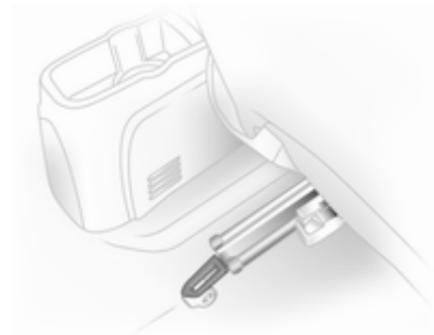
Le garnissage du montant de toit arrière et les points de fixation comportent des symboles indiquant les œillets de fixation auxquels le système de sécurité pour enfant doit être attaché.
