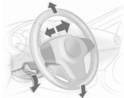
Débloquer le levier, régler le volant puis bloquer le levier et vérifier qu'il est bien verrouillé.
