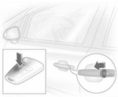
Tourner la clé vers l'avant dans la serrure de la porte du conducteur ou appuyer sur le bouton
