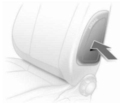
Le système d'airbag latéral se compose d'un airbag dans chacun des dossiers de siège avant et dans les dossiers des sièges arrière extérieurs. Ils sont reconnaissables à l'inscription **AIRBAG**.
