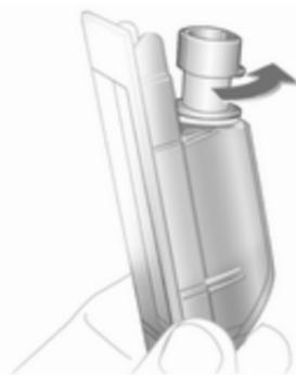
4. Faire tourner la douille de l'ampoule dans le sens antihoraire pour la désencliquer.
