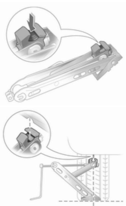
4. Régler le cric à la hauteur requise avant de le positionner directement sous le point de levage de manière telle qu'il ne glisse pas.
