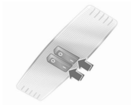
Actionnement avec commutateur (I = marche, 0 = arrêt, position centrale = éclairage automatique).
