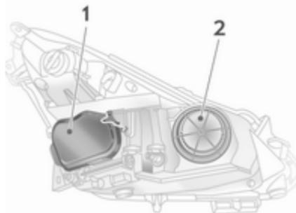
Phares avec systèmes séparés pour les feux de croisement **1** (ampoules extérieures) et les feux de route **2** (ampoules intérieures).
