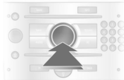
Pour mettre en surbrillance les options de menu ou les commandes et pour sélectionner les fonctions, tourner la commande multifonction.
