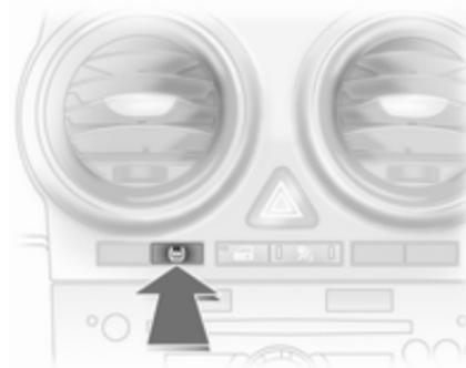
Après une correction de la pression de gonflage ou un changement de roue, il faut initialiser le système : mettre le contact, enfoncer et maintenir le bouton **DDS** pendant 4 secondes environ, le témoin (⚠) clignote trois fois.
