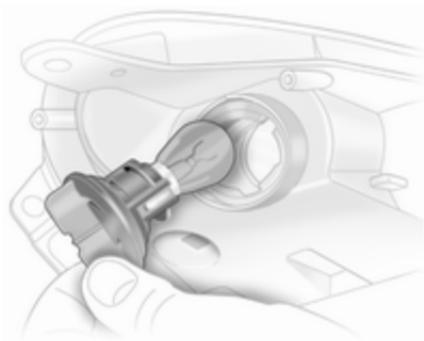
2. Pousser légèrement l'ampoule dans la douille, la tourner dans le sens antihoraire, l'enlever et remplacer l'ampoule.
