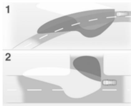
Le faisceau lumineux pivote en fonction de la position du volant et de la vitesse.
