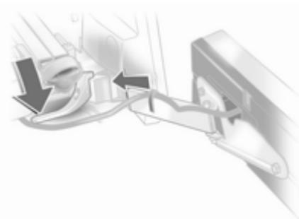
Abaisser le levier de blocage et pousser le support d'ampoules dans le dispositif de retenue jusqu'à ce qu'il touche la butée.
