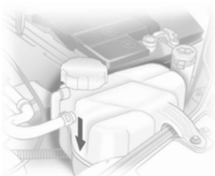
Si le système de refroidissement est froid, le niveau de liquide de refroidissement doit se trouver au-dessus du repère **KALT/COLD**. Faire l'appoint si le niveau est bas.
