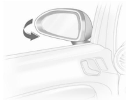
Les rétroviseurs extérieurs peuvent être rabattus en appuyant légèrement sur le bord extérieur du boîtier.
