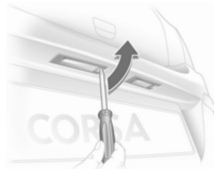
1. Introduire le tournevis dans le boîtier de l'ampoule ; appuyer sur le côté et déverrouiller le ressort.
