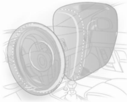
Le mouvement vers l'avant des occupants avant est décéléré, ce qui réduit considérablement le risque de blessure de la tête et de la partie supérieure du corps.
