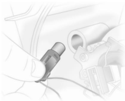
3. Enlever l'ampoule de la douille et remplacer l'ampoule.
