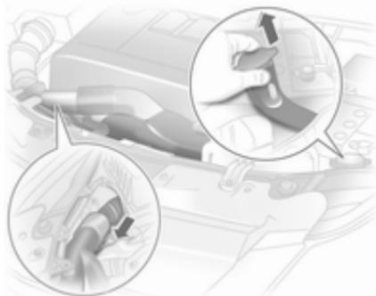
Pour remplacer des lampes sur le côté droit du compartiment moteur, détacher le flexible d'air du filtre à air du côté droit.
