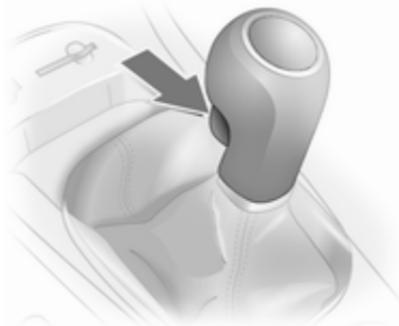
Pour engager la marche arrière lorsque le véhicule est à l'arrêt, soulever le bouton du levier sélecteur 3 secondes après avoir débrayé et engager ce rapport.
