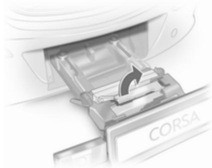
Plier un logement de pédalier, ou les deux, vers le haut jusqu'à ce que le support diagonal s'engage.
