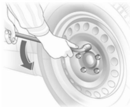
2. Poser la clé de roue en s'assurant qu'elle est bien placée et desserrer chaque vis d'un demi-tour.
