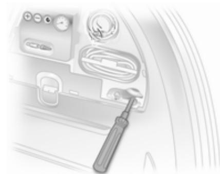
Les outils du véhicule se trouvent dans le compartiment droit du coffre, avec le kit de réparation des pneus.
