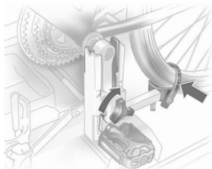
Serrer la vis de blocage de la fixation de pédalier au maximum.
