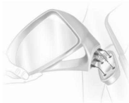
Corsa OPC : afin de protéger les piétons, les rétroviseurs extérieurs de la Corsa OPC sont dégagés de leur support s'ils sont poussés. Placer le boîtier du rétroviseur sur le support en engageant les pattes et en l'encliquetant en frappant légèrement.
