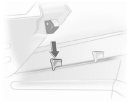
Pour enlever les trois autres éléments (dans l'ordre de 2 à 4), les soulever à l'arrière, les déverrouiller, les tourner et les enlever.
