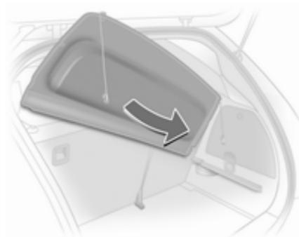
Soulever le cache-bagages vers l'arrière jusqu'à ce qu'il se déverrouille, l'incliner puis l'enlever.
