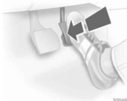
En enfonçant la pédale d'accélérateur au-delà du point de résistance, un rapport inférieur est sélectionné en fonction du régime moteur.
