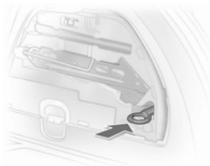
L'œillet de remorquage se trouve dans l'outillage du véhicule ↻ 166. L'œillet de remorquage est rangé dans un logement.
