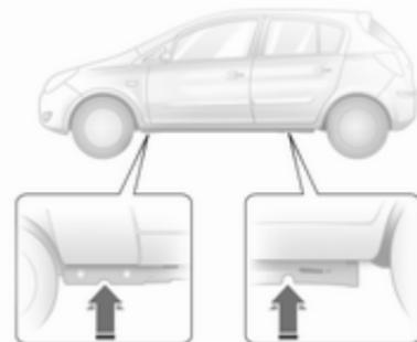
3. Vérifier que le cric est positionné correctement sur un point de levage du véhicule.
