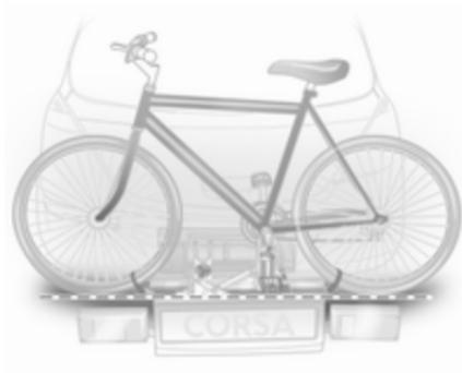
Positionner les logements de roue de sorte que le vélo soit plus ou moins horizontal. La distance entre les pédales et le hayon doit être d'au moins 5 cm (2 pouces).
