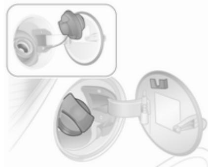
Déverrouiller le bouchon de remplissage avec la clé du véhicule, le dévisser et l'enlever. Le bouchon de remplissage peut être déposé dans le support sur la trappe à carburant.
