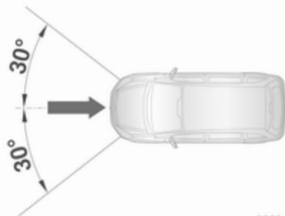
Le système d'airbags avant se déclenche en cas d'accident à partir d'une certaine gravité dans la zone indiquée. Le contact doit être mis.
