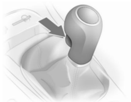
Marche arrière : lorsque le véhicule est à l'arrêt, soulever le bouton du levier sélecteur 3 secondes après avoir enfoncé la pédale d'embrayage et engager la marche arrière.
