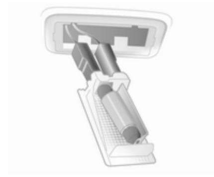
2. Sortir l'ampoule en la poussant légèrement dans la direction de la languette-ressort.
