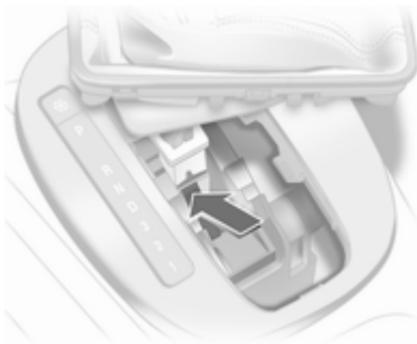
3. Pousser le loquet jaune vers l'avant à l'aide d'un tournevis et sortir le levier sélecteur de la position **P**. Si la position **P** est à nouveau engagée, le levier sélecteur sera à nouveau verrouillé dans cette position. Faire corriger la cause de la coupure de courant par un atelier.
