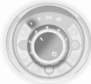
Commutateur d'éclairage positionné sur **A** : Lorsque le moteur tourne, les feux de croisement s'allument en fonction des conditions de luminosité extérieures.
