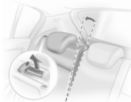
Tirer la manette de déverrouillage, tirer le dossier vers l'avant en position verticale et le verrouiller.
