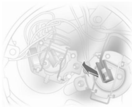
2. Débrancher le connecteur de l'ampoule.
