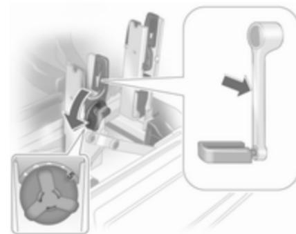
À l'aide du levier rotatif du logement de pédalier, adapter grossièrement l'unité réglable de pédalier au débordement de la manivelle de pédale.
