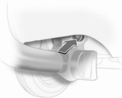
**Œillet pour câble de rupture d'attelage**
