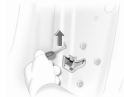
Introduire la clé dans l'ouverture au-dessus de la serrure à l'intérieur de la porte et manœuvrer la serrure en soulevant la clé jusqu'au déclic. Fermer alors la porte. La procédure doit être effectuée pour chaque porte. La porte du conducteur peut aussi être verrouillée depuis l'extérieur à l'aide de la clé. La trappe à carburant et le hayon ne peuvent pas être verrouillés.
