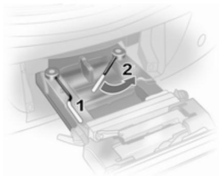
Basculer vers l'arrière le levier de blocage gauche (1) pour commencer, puis le levier de blocage droit (2) jusqu'à ce qu'ils viennent en butée. Les deux leviers de blocage doivent être dirigés vers l'arrière, sinon la sécurité de fonctionnement n'est pas garantie.
