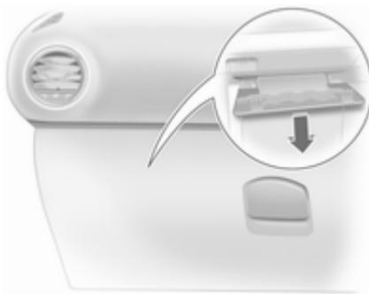
Dans les véhicules avec direction à droite, la boîte à fusibles se trouve derrière un cache dans la boîte à gants. Ouvrir la boîte à gants et retirer le couvercle. Pour fermer le couvercle, commencer par le positionner, puis l'encliqueter en place.
