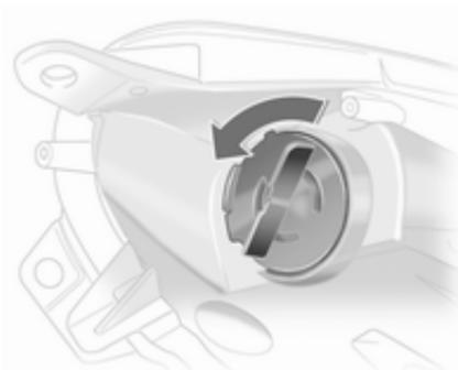
1. Faire tourner la douille de l'ampoule dans le sens antihoraire pour la désencliqueter.
