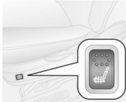
Activer le chauffage en appuyant sur le bouton
