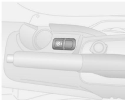
Désactiver manuellement le système d'arrêt-démarrage en appuyant sur le bouton
