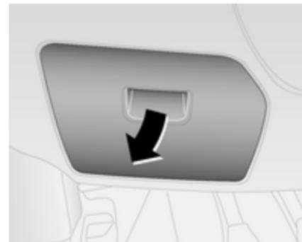
La boîte à fusibles se trouve derrière le cache du tableau de bord, côté conducteur.
