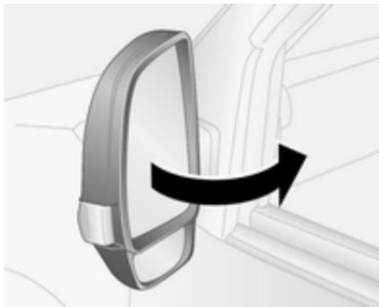
Pour la sécurité des piétons, les rétroviseurs extérieurs se rabattent s'ils sont violemment heurtés. Repositionner le rétroviseur en appuyant légèrement sur son boîtier.
