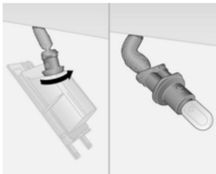
2. Tourner la douille dans le sens antihoraire pour l'enlever du boîtier d'ampoule. Enlever l'ampoule en tirant.
