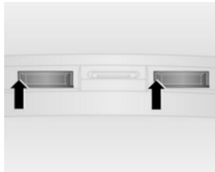
1. Insérer un tournevis comme indiqué par les flèches, appuyer sur le côté et dégager le boîtier d'ampoule.
