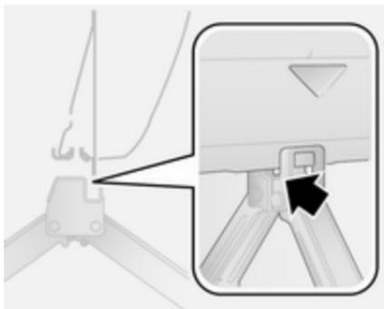
4. Régler le cric à la hauteur requise. Le positionner directement sous le point de levage de manière telle qu'il ne glisse pas.
