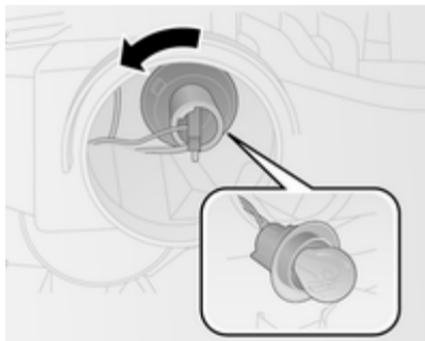
2. Retirer la douille hors du réflecteur en la tournant dans le sens antihoraire.
