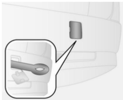
Insérer un tournevis dans la fente sur le côté du capuchon. Dégager le capuchon en faisant levier avec le tournevis. Pour éviter tout dégât, il est recommandé de placer un chiffon entre le tournevis et le cadre.
