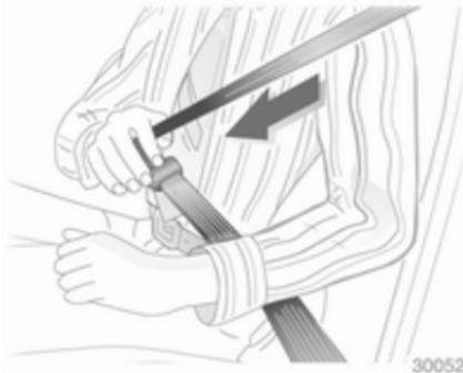
Tirer la ceinture hors de l'enrouleur, la guider sur le corps sans la vriller et insérer le verrou plat dans la serrure. En roulant, tendre régulièrement la sangle abdominale en tirant sur la sangle thoracique. Rappel de ceinture de sécurité ⇨ 62.
