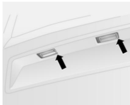
1. Insérer un tournevis comme indiqué par les flèches, appuyer sur la gauche et dégager le boîtier d'ampoule.
