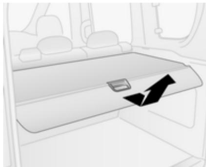
Enlever le cache-bagages des fixations à droite et à gauche. Maintenir le cache-bagages et le guider jusqu'à ce qu'il soit complètement enroulé.
