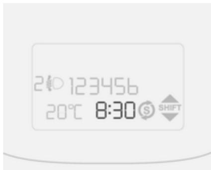
Appuyer sur le bouton **SET ESC**. Faire défiler avec ▲ ou ▼ jusqu'à ce que **Régl. heure** s'affiche. Appuyer sur **SET ESC**.
