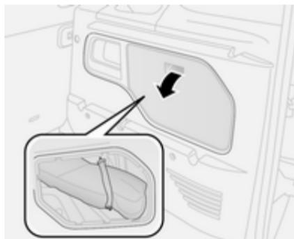
L'outillage et l'équipement de levage du véhicule se trouvent dans le coffre.
