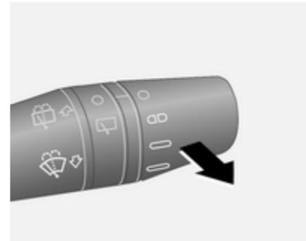
Tirer brièvement sur la manette : du liquide de lave-glace est pulvérisé sur le pare-brise et l'essuie-glace effectue quelques balayages.
