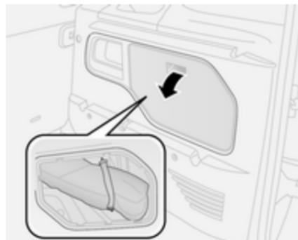
Le kit de réparation des pneus se trouve sur le côté droit du coffre, derrière un cache.
