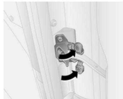
Les portes sont maintenues dans une position à 90° grâce à des limiteurs d'ouverture. Pour ouvrir les portes à 180°, pousser le loquet et pivoter la porte à la position désirée.
