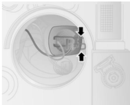
4. Introduire la nouvelle ampoule dans le réflecteur de sorte que l'ampoule soit alignée avec le logement du réflecteur.
