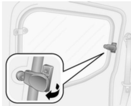
Pour ouvrir, déplacer le levier vers l'extérieur jusqu'à ce que la vitre soit totalement ouverte.
