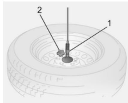
8. Passer la fixation 1 à travers le trou central de la jante en introduisant la goupille de positionnement dans un des trous de vis et en serrant avec le bouton à croisillon 2.
