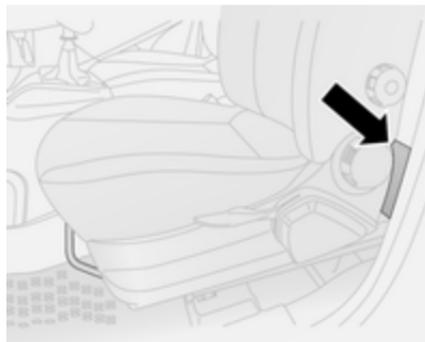
L'outillage et l'équipement de levage du véhicule se trouvent dans le compartiment de rangement derrière le siège avant.
