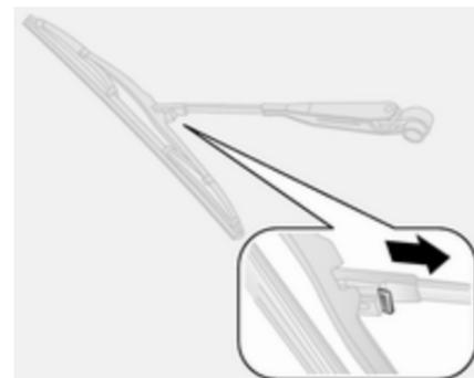
Soulever le bras d'essuie-glace, comprimer et maintenir le clip de fixation puis détacher le balai d'essuie-glace. Fixer le balai de l'essuie-glace légèrement à un angle par rapport au bras de l'essuie-glace jusqu'à ce qu'il s'encliquette.
