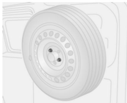
1. Dévisser les deux vis à l'aide de la clé de roue et enlever la roue de secours de son support. Outillage de bord ⇨ 121.
