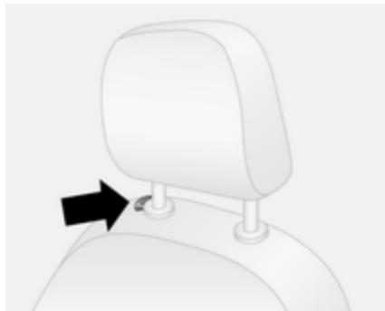
Appuyer sur le loquet de déblocage, régler la hauteur et encliqueter.
