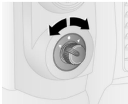
Sélectionner le rétroviseur extérieur concerné en tournant la commande vers la gauche ◀ ou la droite ▶. Puis pivoter le bouton de commande pour régler le rétroviseur.
