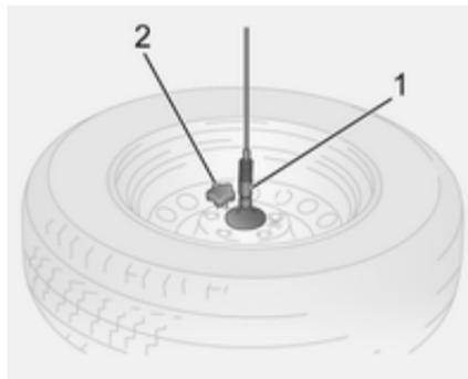
5. Dévisser le bouton à croisillon 2 et détacher la fixation de câble 1 de la roue de secours.
