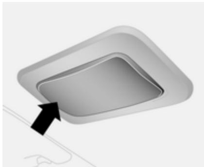
Position centrale du commutateur : éclairage automatique de l'habitacle. Pour une commande manuelle quand les portes sont fermées, appuyer sur l'un des côtés de la lentille.
