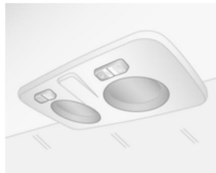
Position centrale du commutateur : éclairage automatique de l'habitacle. Peut être commandé individuellement ou conjointement avec le commutateur  $\equiv D$  quand les portes sont fermées.
