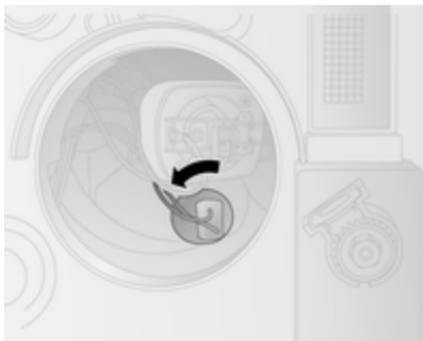
2. Retirer la douille d'ampoule de feu de position hors du réflecteur en la tournant dans le sens antihoraire.
