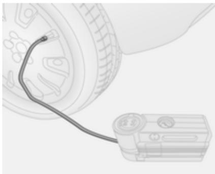
5. Visser le flexible de remplissage sur la valve du pneu.
