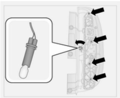
4. Dévisser les quatre vis de fixation à l'aide d'un tournevis. Tourner la douille de feu de recul dans le sens antihoraire et remplacer l'ampoule.
