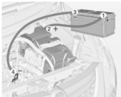
Séquence de raccordement des câbles :
