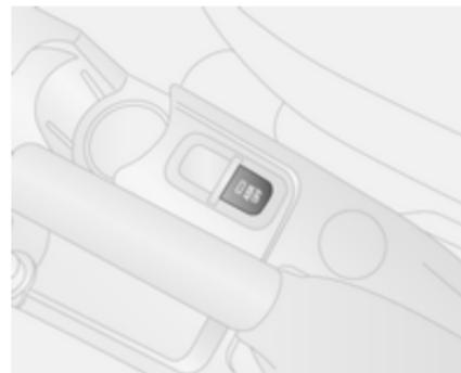
L'ASR peut être désactivé quand le patinage des roues est requis : appuyer sur le bouton **ASR OFF** brièvement.
