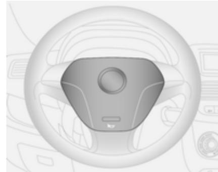
Le système d'airbag avant se déclenche en cas de collision frontale d'une certaine gravité. Le contact doit être mis.
