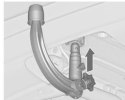
Insérer la barre d'attelage serrée dans l'ouverture et la pousser fermement vers le haut jusqu'à ce qu'un déclic de verrouillage se fasse entendre. La poignée rotative reprend sa position de départ en reposant sur la barre d'attelage, sans jeu.
