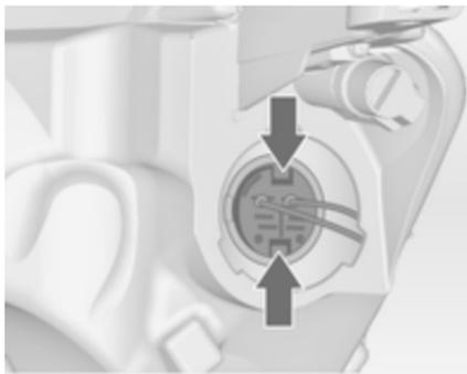
2. Comprimer les ergots et retirer la douille d'ampoule du réflecteur.
