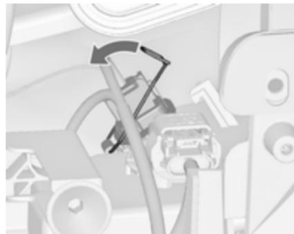
1. Désencliqueter l'attache ressort, puis la pivoter vers l'arrière.
