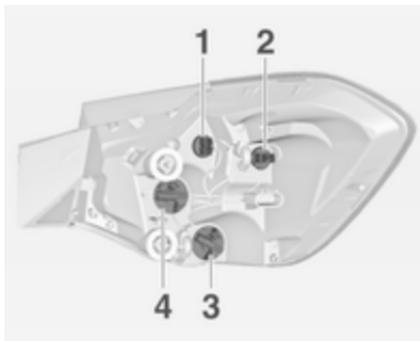
5. Enlever et remplacer l'ampoule.
