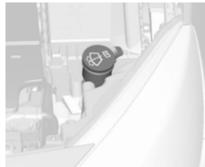
Remplir avec de l'eau propre mélangée d'une quantité adéquate de produit de lave-glace contenant de l'antigel. La composition correcte du mélange est indiquée sur le réservoir du liquide de lave-glace.
