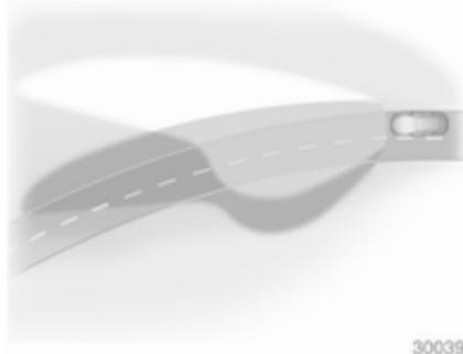
Le faisceau lumineux pivote en fonction de l'angle de braquage du volant et la vitesse, ce qui améliore l'éclairage des virages.
