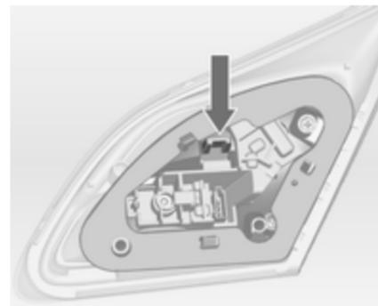
4. Enfoncer la patte de retenue et enlever le support d'ampoule de l'ensemble de feu arrière.
