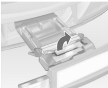
Déployer un ou les deux logements de manivelle de pédale vers le haut jusqu'à ce que le support diagonal se verrouille.
