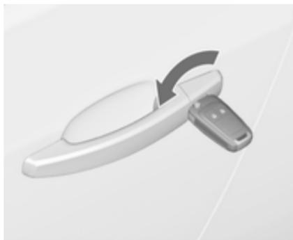
Déverrouiller manuellement la porte du conducteur en tournant la clé dans la serrure. Mettre le contact et appuyer sur le bouton de verrouillage central
