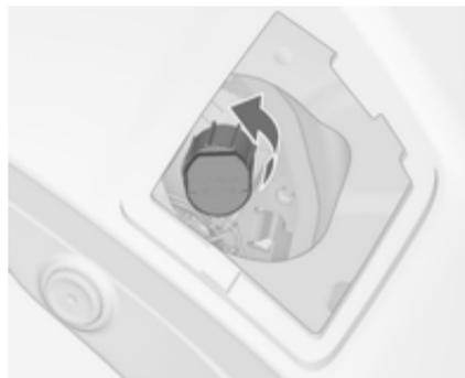
2. Retirer et remplacer l'ampoule de feu antibrouillard arrière.
