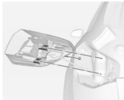
4. Déposer avec précaution l'ensemble de feu arrière. Veiller à ce que la goulotte de câbles reste en place.
