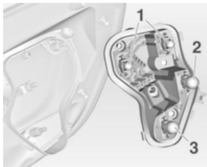
7. Enlever et remplacer l'ampoule.
