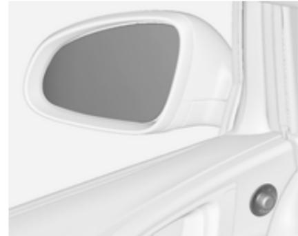
Sélectionner le rétroviseur extérieur souhaité en tournant la commande à gauche (**L**) ou à droite (**R**). Puis pivoter le bouton de commande pour régler le rétroviseur.
