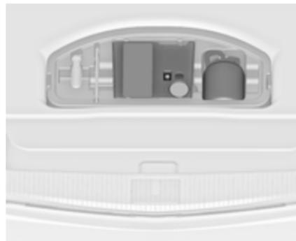
Le kit de réparation des pneus se trouve dans un espace de rangement sous le recouvrement de plancher du coffre ou dans l'espace de rangement sous le siège ↗ 58.
