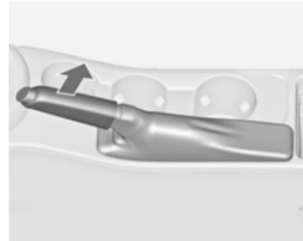
Serrer toujours le frein de stationnement sans actionner le bouton de déverrouillage. Dans une pente ou dans une côte, le serrer aussi fort que possible.
