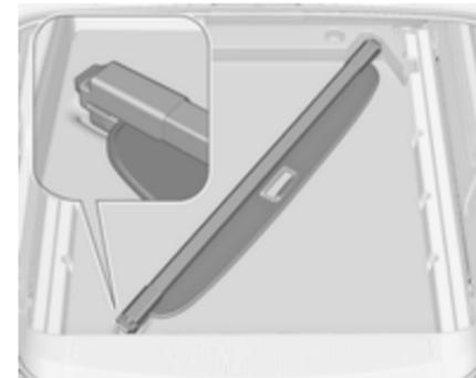
Une fois retiré, le cache peut être rangé sous le recouvrement de plancher arrière comme illustré.
