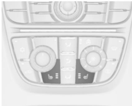
En fonction du niveau de chauffage voulu, appuyer une ou plusieurs fois sur le bouton
