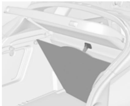
Le recouvrement de plancher arrière peut être soulevé et accroché grâce à la boucle.
