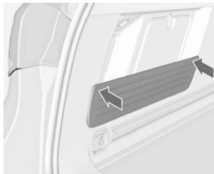
Lors de l'assemblage, enfoncer le cache dans les pastilles en caoutchouc pour obtenir une force de fixation maximale.
