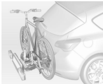
Le système de transport arrière (système Flex-Fix) permet de fixer des vélos au support de transport extractible intégré dans le plancher du véhicule.
