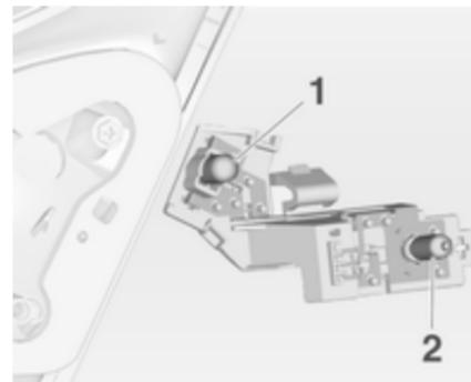
5. Pour remplacer le feu arrière (1), enlever et remplacer l'ampoule.
