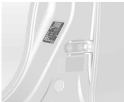
Pression de gonflage ⇨ 241 et sur l'étiquette apposée sur le cadre de porte avant gauche.
