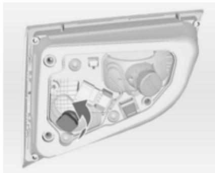
4. Enlever et remplacer l'ampoule.
