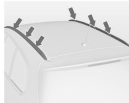
Pour fixer la galerie de toit, insérer les boulons de fixation dans les orifices montrés sur la figure.
