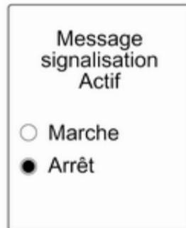
Une fois que la page des réglages est affichée, sélectionner **Arrêt** pour désactiver la fonction de surimpression. La réactivation s'opère en sélectionnant **Marche** ou à chaque fois que le contact est remis.
