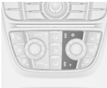
Appuyer sur le bouton inférieur pour diminuer ou sur le bouton supérieur pour augmenter la vitesse de la soufflerie
