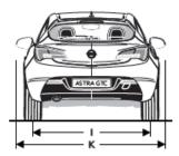
H Voie avant : A Empattement : 2 695 mm B Longueur hors tout : I Voie arrière : 4 466 mm C Longueur avec attelage : J Largeur (sans rétroviseurs) : 4 581 mm E Porte-à-faux avant : K Largeur (avec rétroviseurs): 968 mm F Porte-à-faux arrière : L Hauteur à vide : 803 mm G Porte-à-faux arrière avec attelage : 918 mm
