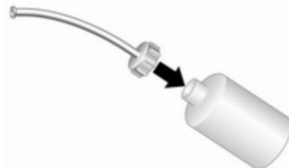
1. Agiter la bouteille de produit d'étanchéité, enlever le bouchon et visser le flexible de remplissage sur la bouteille de manière à percer le capuchon intérieur.
