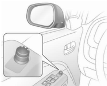
Sélectionner le rétroviseur extérieur souhaité en tournant la commande vers la gauche (L) ou la droite (R). En position centrale, aucun rétroviseur n'est sélectionné.
