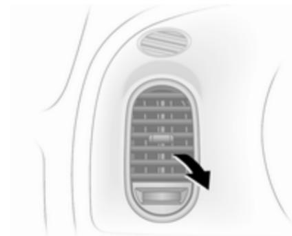
Diriger le débit d'air en basculant les lamelles et en tournant la roue moletée à gauche ou à droite.
