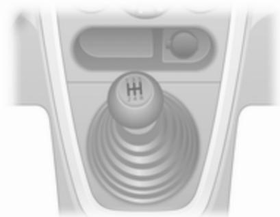
Marche arrière : avec le véhicule à l'arrêt, attendre 3 secondes après avoir débrayé avant d'engager le rapport.
