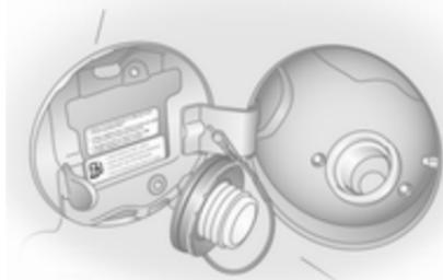
Pour ouvrir le bouchon de remplissage de carburant : le tourner dans le sens antihoraire.
