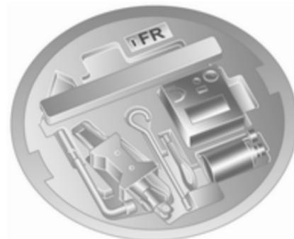
Le kit de réparation des pneus se trouve sous le recouvrement de plancher du coffre.
