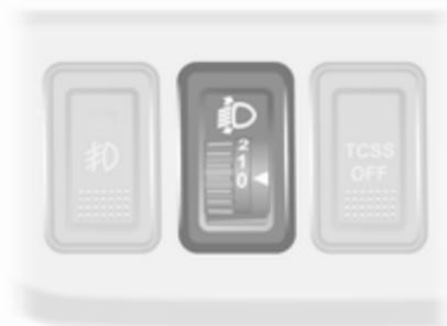
Pour adapter la portée des phares en fonction du chargement du véhicule afin d'éviter l'éblouissement : tourner la roue moletée dans la position désirée.
