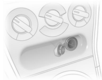
Une prise pour accessoires 12 V est disposée dans la console centrale et est fonctionnelle quand le commutateur d'allumage est en position **ACC** ou **ON**.
