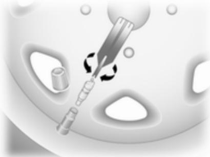
2. Dévisser le capuchon de valve du pneu défectueux et dévisser l'obus de valve à l'aide de l'outil de dépose fourni.
