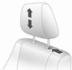
Appuyer sur le bouton de déverrouillage, régler la hauteur, verrouiller. Appuis-tête ↷ 27.
