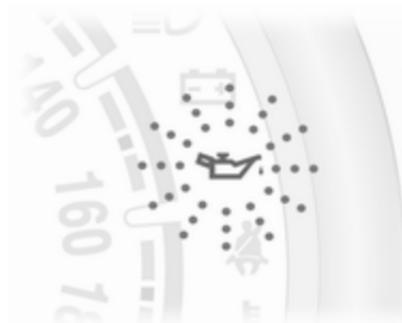
Quand le système a calculé que la durée de vie de l'huile a été réduite, 🛑 clignote dans le combiné d'instruments quand le moteur tourne. Faire changer l'huile moteur et le filtre par un atelier dans un délai d'une semaine ou 500 km (selon l'échéance survenant en premier).
