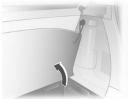
Pour accéder au compartiment de rangement dans le plancher arrière, soulever le recouvrement de sol en utilisant la sangle centrale se trouvant près de la gâche de hayon et accrocher la boucle au crochet présent.
