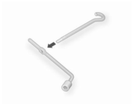
4. Attacher la manivelle de cric à la clé de vis de roue (comme montré sur l'illustration) et introduire l'extrémité en crochet de la manivelle de cric à travers l'œillet du cric.
