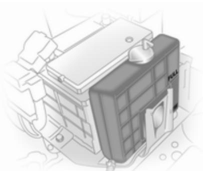
Si le système de refroidissement est froid, le niveau de liquide de refroidissement doit se trouver entre les repères **FULL/LOW**. Faire l'appoint si le niveau est bas.
