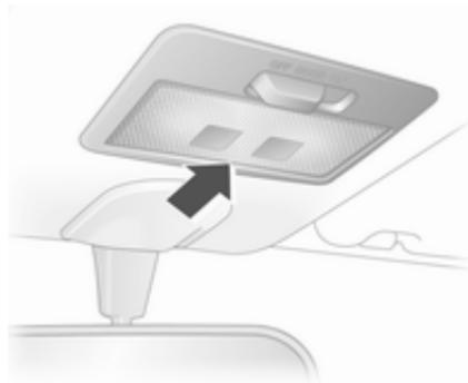
1. À l'aide d'un tournevis adéquat enveloppé dans un chiffon, faire levier pour extraire la lentille de la garniture du toit.
