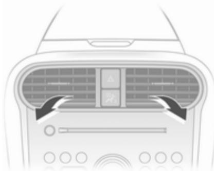
Le débit d'air peut être dirigé comme désiré en basculant les lamelles vers le haut et le bas et en utilisant la roue moletée centrale pour l'orientation latérale.
