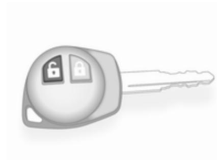
Appuyer sur le bouton
