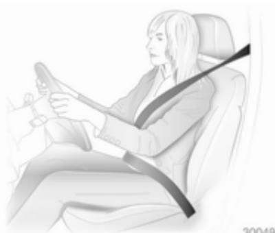
Tirer la ceinture de sécurité et l'encliqueter dans la serrure de ceinture. La ceinture de sécurité ne doit pas être vrillée et doit être placée près du corps. Le dossier ne doit pas être incliné trop en arrière (environ 25° maximum).
