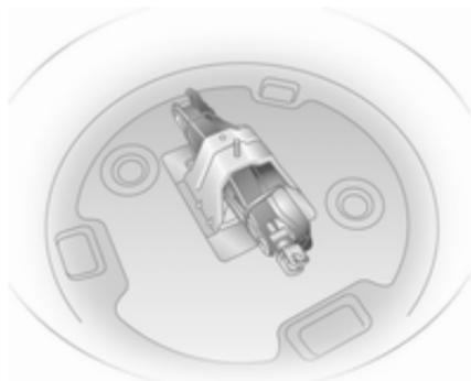
Le cric et les outils se trouvent dans un compartiment de rangement sous la roue de secours dans le coffre. Roue de secours ↗ 122.
