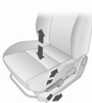
Actionner le levier par des mouvements de pompage
