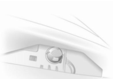
1. Enlever le support d'ampoule en le tournant et en le tirant hors du véhicule.
