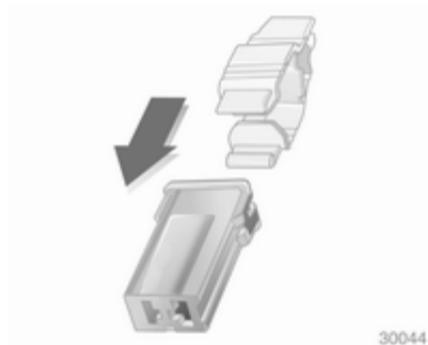
Pour faciliter le remplacement des fusibles, une pince à fusibles se trouve dans la boîte à fusibles.
