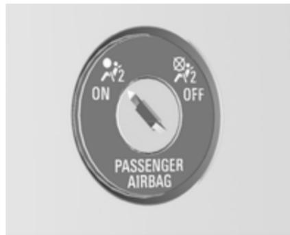
Le système d'airbags de passager avant peut être désactivé à l'aide d'une serrure située sur le côté du tableau de bord, visible quand la porte de passager avant est ouverte.
