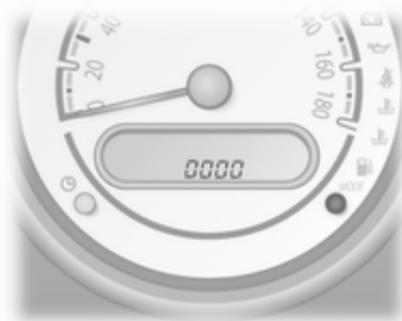
Pour modifier le niveau de brillance, allumer les phares et appuyer plusieurs fois sur le bouton **MODE** jusqu'à ce que les carrés indiquant le niveau de brillance apparaissent dans l'affichage du compteur kilométrique.
