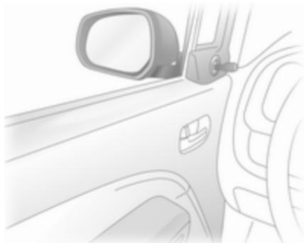
Régler les rétroviseurs en basculant le levier dans le sens souhaité.
