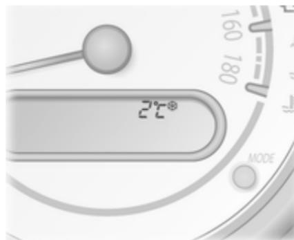
La température extérieure apparaît dans l'affichage du compteur kilométrique quand le contact est mis.
