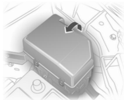
La boîte à fusibles se trouve dans le compartiment moteur à côté de la batterie.
